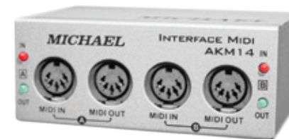
AKM14 Interface MIDI Michael. Sistema de alimentação via USB, MIDI IN / MIDI OUT, canais midi, conexão USB / PC / MAC, compatibilidade para Windows XP, Vista e MAC OS, não é necessário instalação de Driver com sistema plug and play (cabos de conexão removíveis). Permite interface simultânea de instrumentos (teclados).
